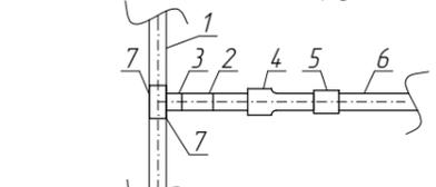
1. Существующий газопровод низкого давления  $\phi 108$  мм.
